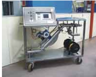
Figuur 19: in situ kalibratie met een referentiemeter
