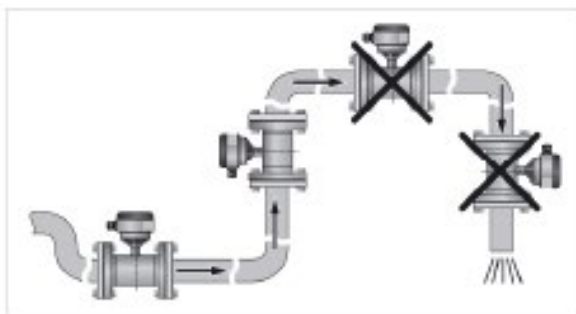
Figuur 16: correcte installatie op laagste punt (links); foutieve installatie op hoogste punt (boven) en voor open uitlaat (rechts)
