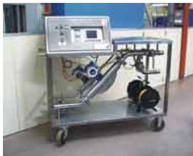
Figuur 19: in situ kalibratie met een referentiemeter
