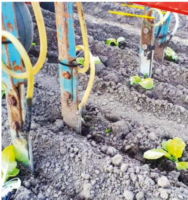
Toepassing van ammoniumzouten via injectie om ammoniakemissies te verminderen
