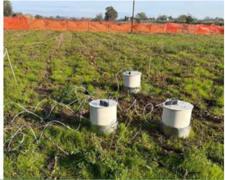
Meting ter plaatse van ammoniakemissies door windtunneltechniek (links) en broeikasgasemissies door statische kamer (rechts)
